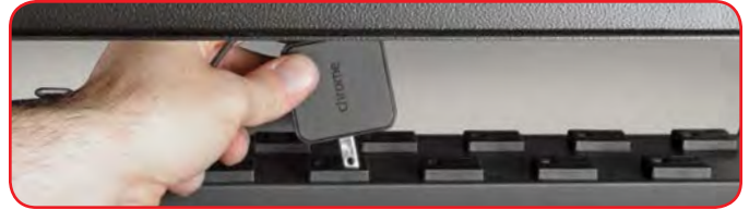
Los modelos de CA proporcionan un tomacorriente dedicado para cada dispositivo.
