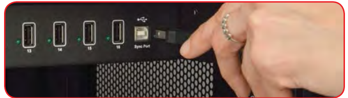
El puerto USB de enlace de subida se conecta a una computadora para sincronizar dispositivos.
