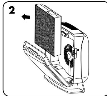
2 Abra el panel frontal presionando los pestillos en ambos lados de la unidad. Deje que el panel se abra completamente. Retire el o los filtros que se reemplazarán.
