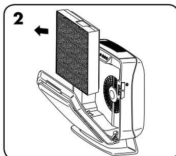
2 Ouvrir le panneau d'accès frontal en appuyant sur les loquets situés des deux côtés de l'unité. Laisser le panneau s'ouvrir complètement. Retirer les filtres à remplacer.
