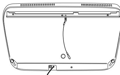
Une fois le support mural monté, demandez à une autre personne de vous aider à soulever le purificateur d'air et préparez-vous à l'installer sur le support mural. Soulevez l'appareil de manière à positionner le support de l'appareil par-dessus le support mural. Inclinez l'appareil à environ 45 degrés et abaissez-le jusqu'à ce que le support de l'appareil repose sur le support mural.
