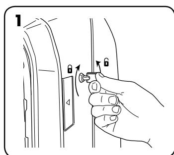
Déverrouiller le panneau d'accès : pour déverrouiller, insérer la clé fournie et la faire tourner d'un quart de tour dans le sens antihoraire.
