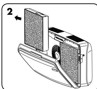
Ouvrir le panneau d'accès frontal en appuyant sur les loquets situés des deux côtés de l'unité. Laisser le panneau s'ouvrir complètement. Retirer les filtres à remplacer.
