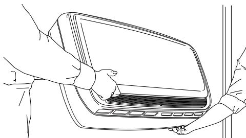
Con cuidado, incline la máquina hasta que quede apoyada verticalmente, sostenida por el soporte del lado de la pared, y el pestillo de extracción se haya trabado. Es posible que sea necesario deslizar suavemente la máquina hacia la izquierda o hacia la derecha para asegurarse de que el pestillo esté completamente trabado. Se escuchará un suave clic cuando el pestillo se trabe.
